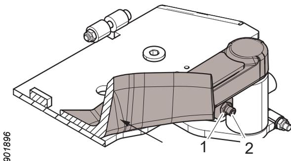
1. Afloje la tuerca de seguridad del tornillo de ajuste (1).
