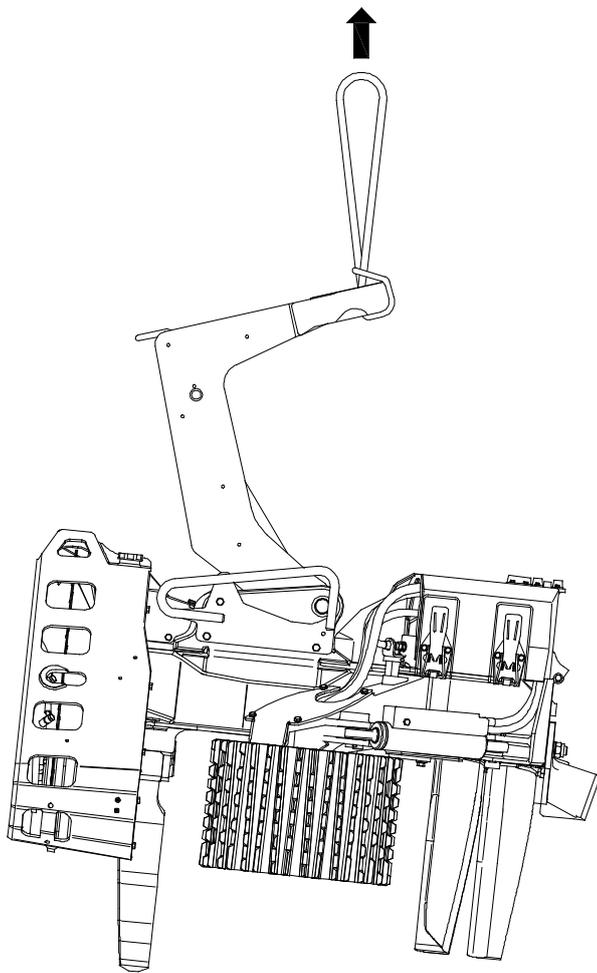
Cuando transporte un cabezal suelto, colóquelo en un palé en posición horizontal. Las cuchillas de desrame y los brazos de los rodillos deben estar cerrados. Deben atornillarse bloques de madera al palé para proporcionar apoyo a todas las cuchillas de desrame y rodillos de alimentación. El peso del cabezal debe estar distribuido uniformemente entre las cuchillas de desrame y los rodillos de alimentación.
