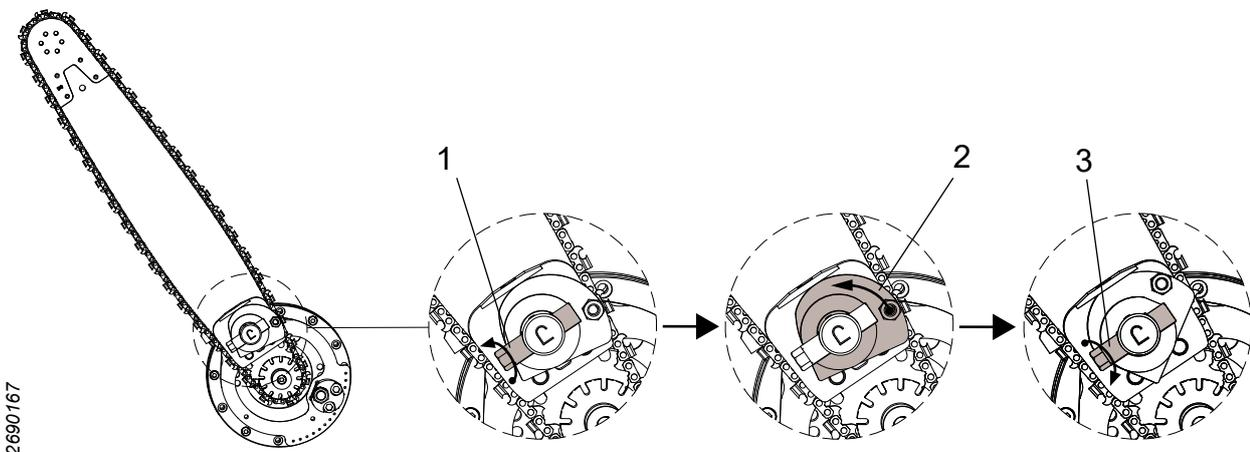
1. Lockern Sie die Vorspannung am Sägeschwert, indem Sie den Riegelbolzen gegen den Uhrzeigersinn drehen. Der Riegelbolzen braucht nur so weit gedreht werden, bis die Vorspannung nachlässt.
