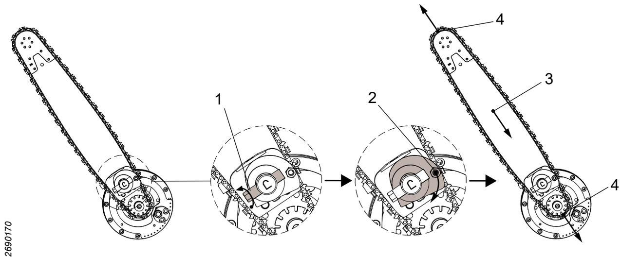
1. Lockern Sie die Vorspannung am Sägeschwert, indem Sie den Riegelbolzen gegen den Uhrzeigersinn drehen. Der Riegelbolzen braucht nur so weit gedreht werden, bis die Vorspannung nachlässt.
