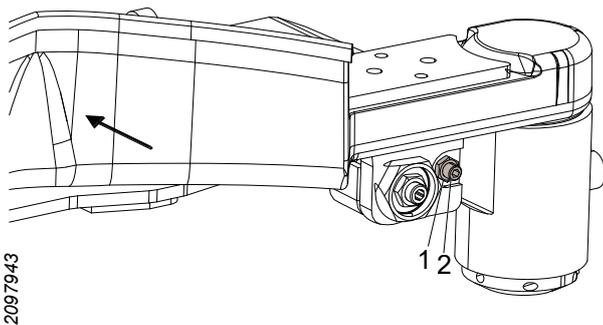
1. Lösen Sie die Befestigungsmutter (1) der Stellschraube.
